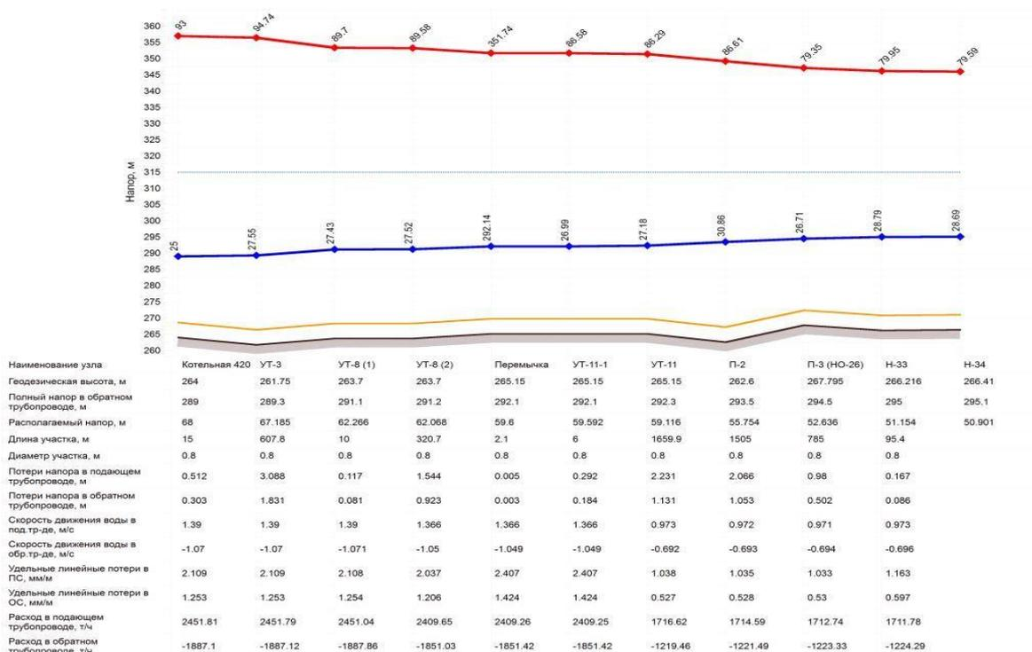
**Рисунок 12. Пьезометрический график**
