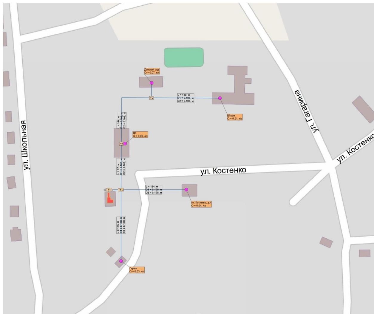
Рисунок 14. Зона действия котельной МУП «Еланское ЖКХ» (расчетная схема)
