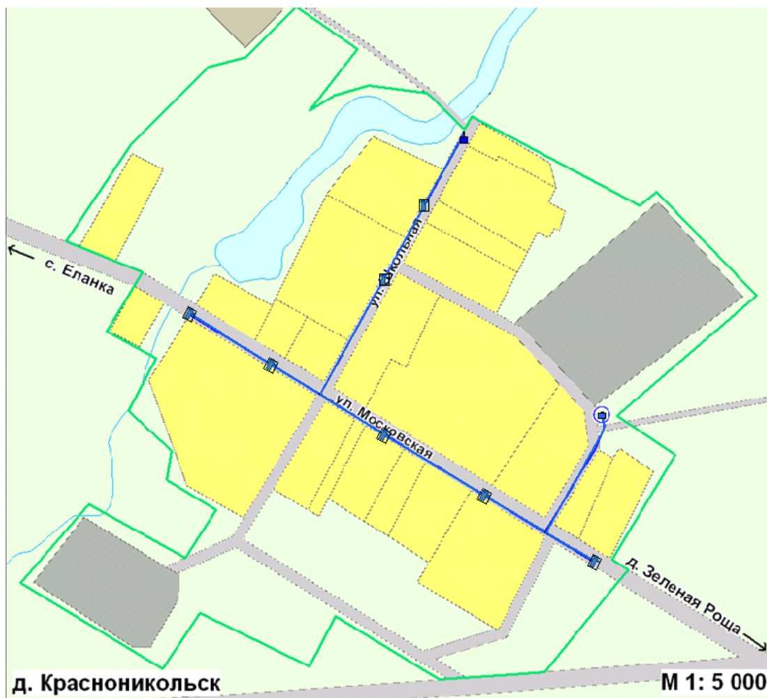
Рисунок 1 - Зона действия централизованного водоснабжения д. Красноникольск
